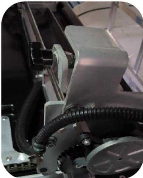
Passo 2.: Aprire manualmente il coperchio mobile facendolo scorrere all'esterno fino a quando il telaio di sollevamento è perpendicolare al suolo
