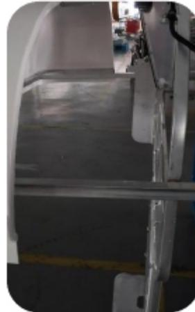
Passo 3: Utilizzare la funzione manuale per staccare completamente i denti del motore dall'albero di trasmissione. Fare la massima attenzione tendendo la sedia a rotelle e abbassandola lentamente per evitare che cada improvvisamente a terra una volta liberato il sistema.
