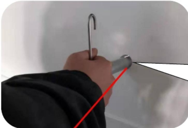
Ruotare manualmente con il tubo di alluminio in dotazione in senso antiorario fino a che la rotazione si arresta e quindi gli ingranaggi si sono distaccati dalla cremagliera
